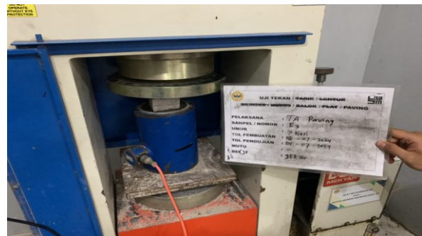
Gambar 2. Proses Pengujian Kekuatan Paving Blok.
