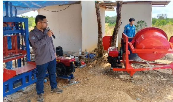
Gambar 3. Alat Cetak Paving Blok dan Pengaduk Campuran.
