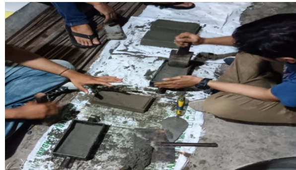
Gambar 1. Proses Pembuatan Paving Blok.
