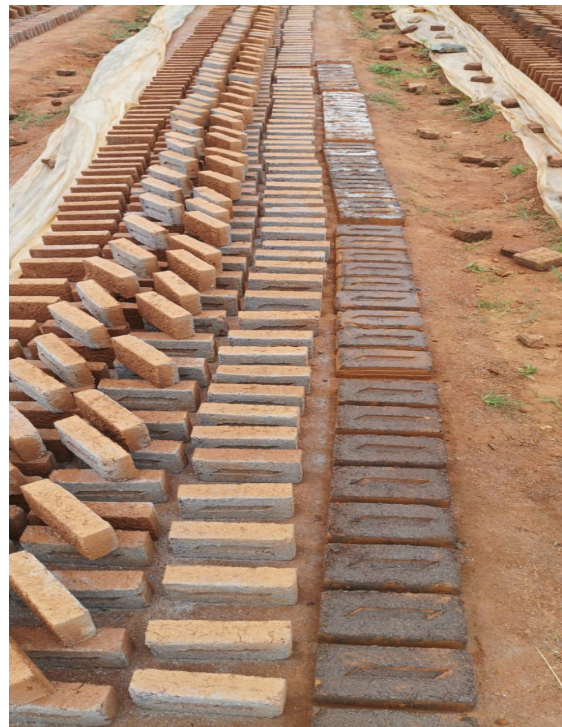
Gambar 10. Batu bata dengan bahan aditif abu kayu akasia berwarna keabu-abuan
